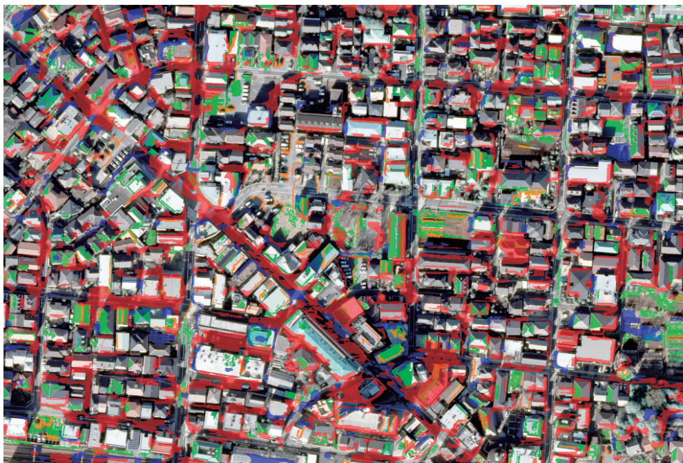
図1 スペクトル情報および数値表層モデル (DSM) を使用した自動検出による新築・取り壊し等の誤検出例 《自動抽出凡例》赤：新築、青：取り壊し、緑：色変化、橙：テクスチャー変化
