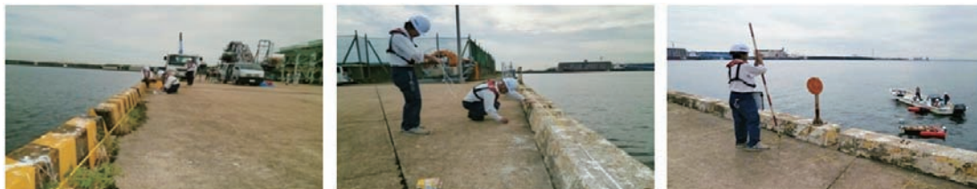
図9 栈橋上の測線位置明示
