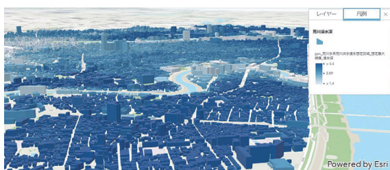
図27 災害発生時の最大浸水深で3D都市モデルを色分け表示した例
