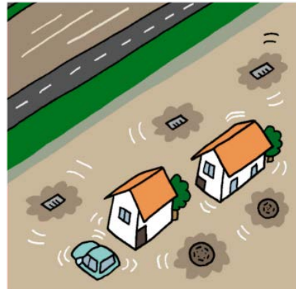
内水氾濫 平坦な土地に強い雨が降ると、排水用の水路や小河川の水が排水しきれず陸域が浸水する現象のこと
