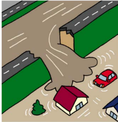
外水氾濫 河川の堤防が決壊または溢水（河川の水の溢れ）により、市街地や農地などの陸域が浸水する現象のこと
