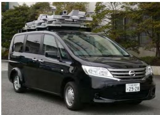
図1 車載型MMS
