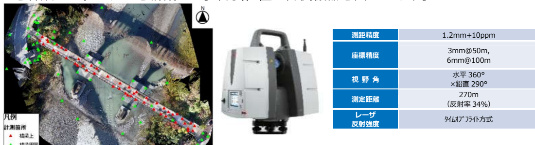
図2. 計測位置と地上レーザスキャナ（参考）
