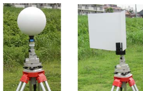
←図 2 使用した球ターゲット(左)と直角ターゲット(右)
